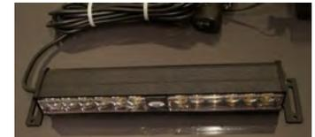
Die verbauten Optiken und die außenliegende Lichtscheibe garantieren einen großen Abstrahlwinkel (vertikal: > 70° / horizontal: > 30°).
